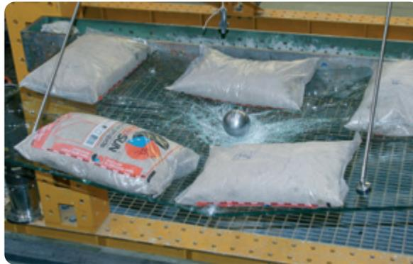
Für dieses Dach ist zwar eine Zustimmung im Einzelfall erforderlich, für Sie halten wir aber den Versuchsbericht mit ausgewählten Abmessungen über die Resttragfähigkeit und eine umfangreiche Statik mit Bemessungsdiagrammen bereit.
